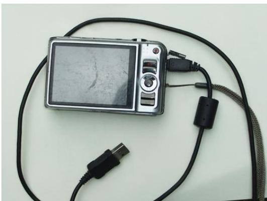
メーカーによってカメラ側の端子形状はすべて異なる。もう一方は USB 端子なので共通。カメラの画像を取り込むソフト (ドライバーという) も必要になるがインターネットからダウンロードできる。
