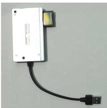
1.2 マルチ・カード・リーダー (Media Multi Card Reader Writer (ELECOM の MR-J003 series など) を利用して接続する方法。カメラの中に入っている SD カードを外して、マルチ・カード・リーダーへ挿入し、パソコンと接続する。
